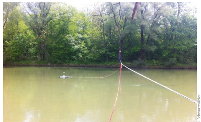
Bild 3: Erhebung von Grundlagendaten für die Kalibrierung numerischer Simulationen mit Hilfe eines ADCP (Acoustic Doppler Velocimeter)
