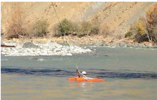
Bild 3: Erhebung von Grundlagendaten für die Kalibrierung numerischer Simulationen mit Hilfe eines ADCP (Acoustic Doppler Velocimeter)
